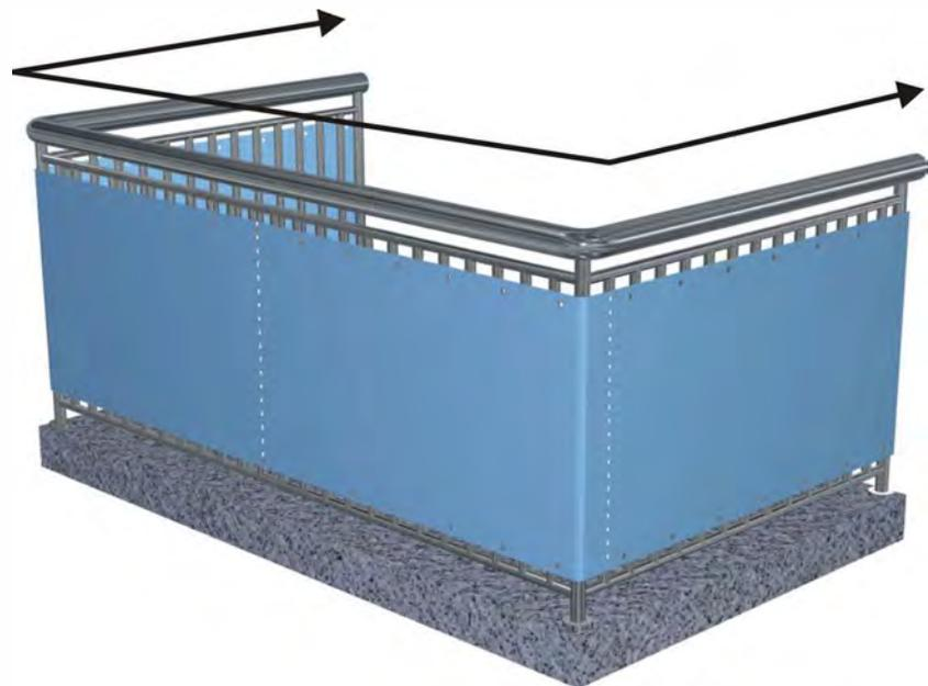
**Messen Sie einmal um den kompletten Balkon herum** für eine durchgängige Bespannung.
