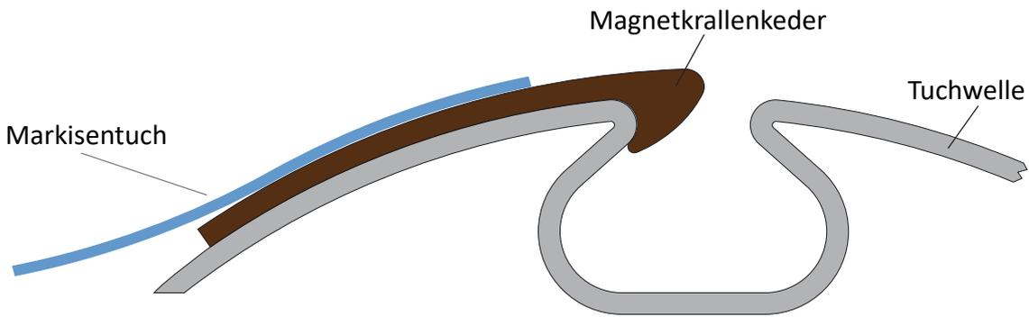
Standardkeder zur Befestigung des Tuches sowie des Volants an der Tuchwelle sowie am Ausfallprofil (in den Größen 4,5 mm und 6,0 mm als Weich- oder Hartkeder erhältlich).
